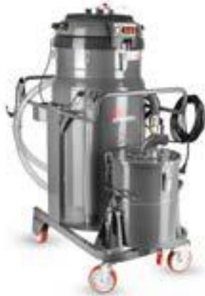
Grazie alla potenza e alla capacità di questa macchina, è possibile recuperare, filtrare dai trucioli ed eventualmente da residui fini (fino a 6 micron) e reimmettere gli oli o le emulsioni nelle macchine CNC. Il Tecnoil 200 permette di minimizzare il fermo macchina per ottenere il massimo della redditività.
